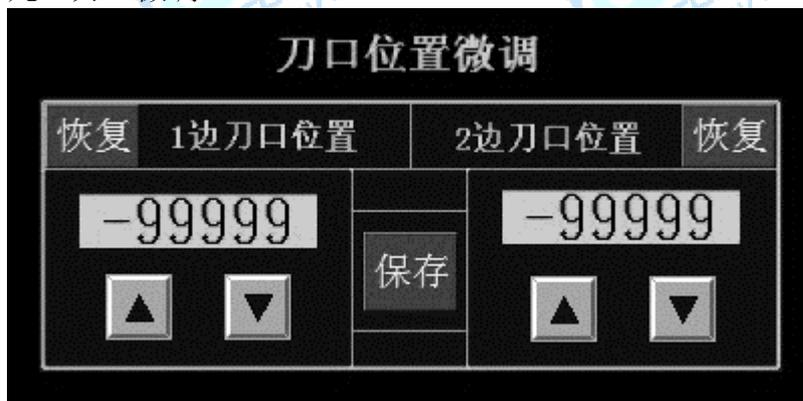
1. 由于电缆的误差可通过刀口微调可调整两刀口剥皮微小差距，并同时保存调整后的数据于当前线号表中。
